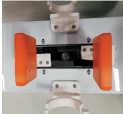
Fig. 2 - Vista superior do Pneuma, sendo visível o sistema de atuação
