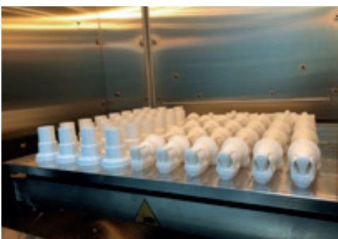
Figura 3 – Sistema Swivel produzido por impressão 3D acoplado a filtro de ar para ventilação não invasiva.
