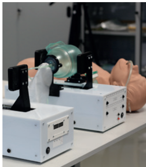
Figura 2 - Semelhante a um ventilador de emergência e transporte, o dispositivo pode ser utilizado sem acesso à rede de energia elétrica (Foto: DR)
