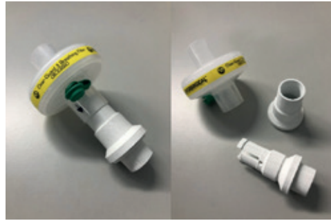
Figura 4 – Sistema Swivel produzido por impressão 3D acoplado a filtro de ar para ventilação não invasiva.
