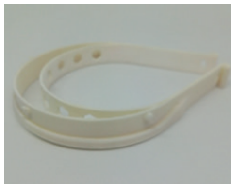
Fig. 1 – Suporte em Duraform PA (Tecnologia SLS)
