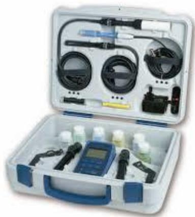
**Figura 20** - Foto do material utilizado para medir a temperatura, oxigênio dissolvido, condutividade e pH
