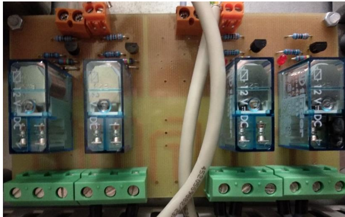
Figura 4.11 Placa do circuito dos relés.
