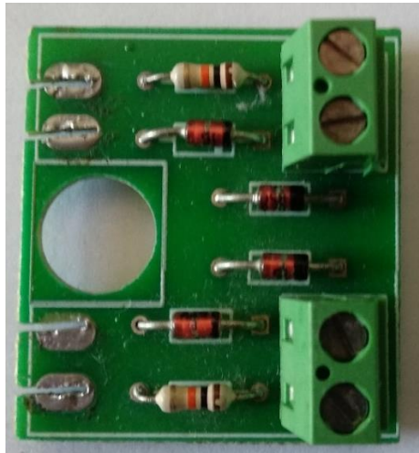
Figura 4.9 Placa do circuito de proteção dos IGBTs.
