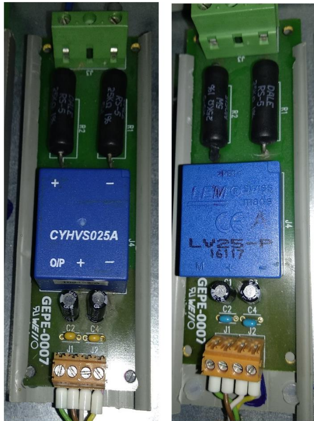
Figura 4.2 Montagem final das placas onde os sensores de tensão estão inseridos.
