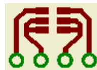
Fig. 131 – PCB da placa do sensor de temperatura do motor
