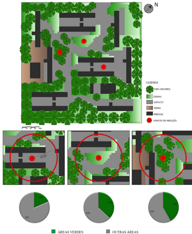
Figura 6 Pontos escolhidos para realização das medições em campo
