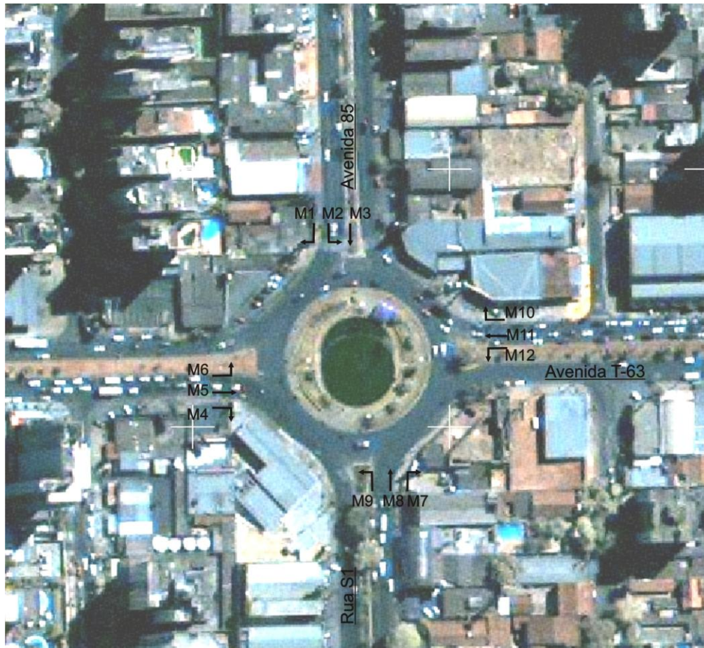
Figura 5 – Movimentos permitidos em cada aproximação da interseção da Avenida T63 com a Avenida 85/Rua S1 (em outubro de 2007).
