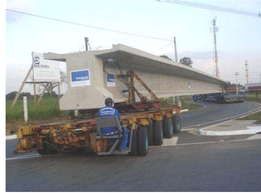
Figura 8 - Visualização do operador da carroceria do caminhão “Dolly” – Obra D
