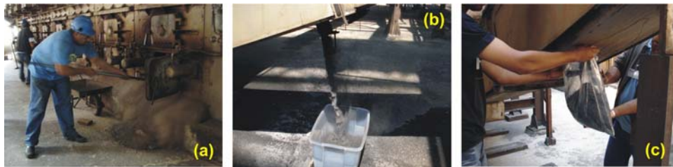
Fig. 2 (a) Retirada da cinza da caldeira; (b) e (c) CBC coletada diretamente dos dutos, na usina da cidade de Barra Bonita
