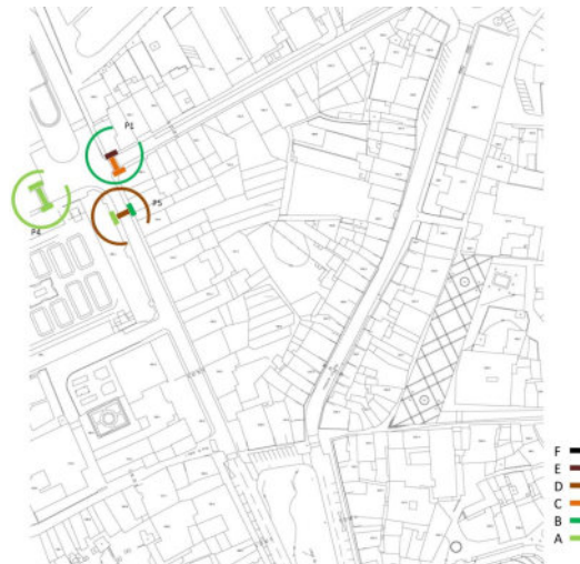
Fig. 2 - Níveis de serviço de cruzamentos com sinais luminosos
