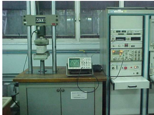
Fig. 1 - Equipamento servo-hidráulico da MTS para ensaios à fadiga
