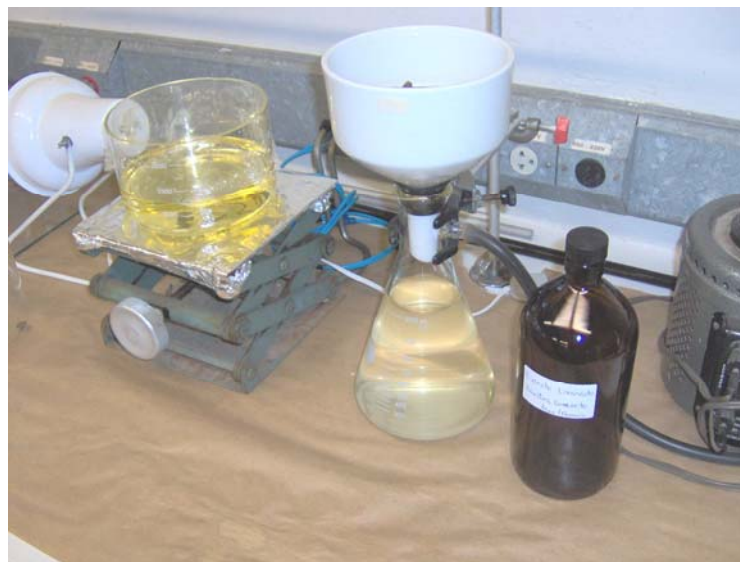
Fig 6 Aparato utilizado na filtração da solução de extração
