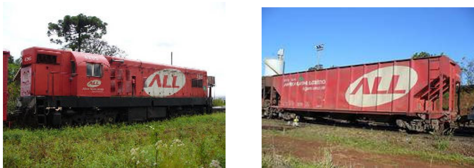
Fig. 3 Locomotiva modelo G12 e vagão tipo hopper
