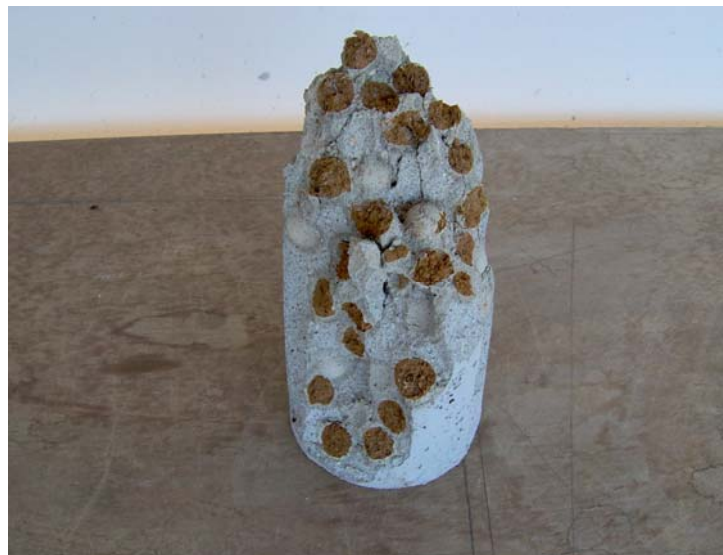
Fig 5 Corpo de prova após ruptura por compressão axial do concreto produzido com o compósito com lodo de ETA e serragem de madeira.
