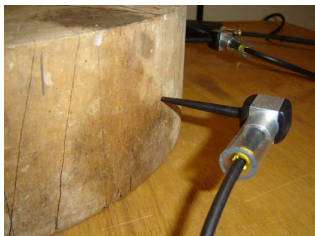
Fig. 4 Posicionamento do sensor no disco de madeira.
