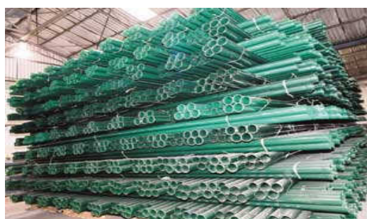
Figura 06 – Tubos de PET reciclado para esgoto fabricados pela EBR. Fonte: Revista Plástico Moderno Ed. 342 (On line), disponível em http://www.plastico.com.br/revista/pm342/reciclagem1.htm
