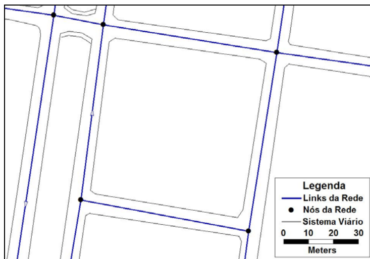
Fig. 1 Mapa em SIG da rede viária obtido a partir do arruamento/sistema viário
