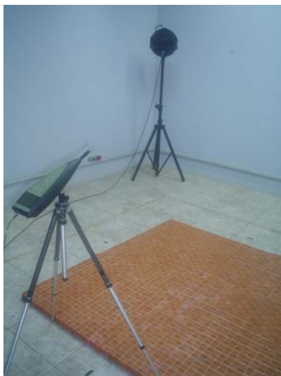
Figura 5 – Ponto P2 e fonte sonora na posição F2 com painel de ressoadores com juntas vedadas
