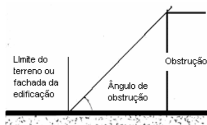
Fig. 2 Corte ilustrando o controle da obstrução através de um ângulo de obstrução
