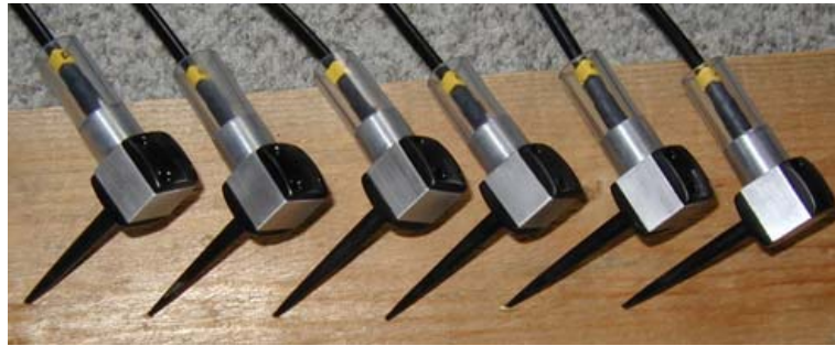
Fig. 2 Sensores de emissão e recebimento da onda sonora.
