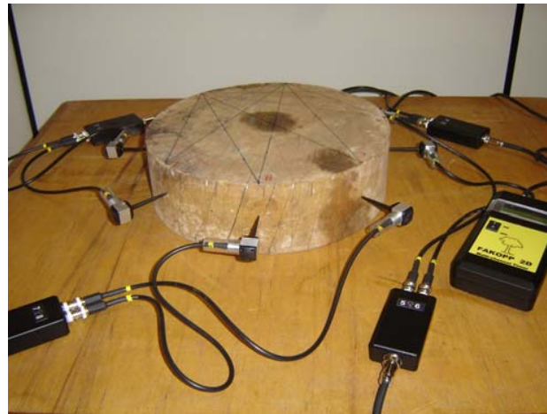
Fig. 3 Ensaio de propagação sonora em disco de madeira.
