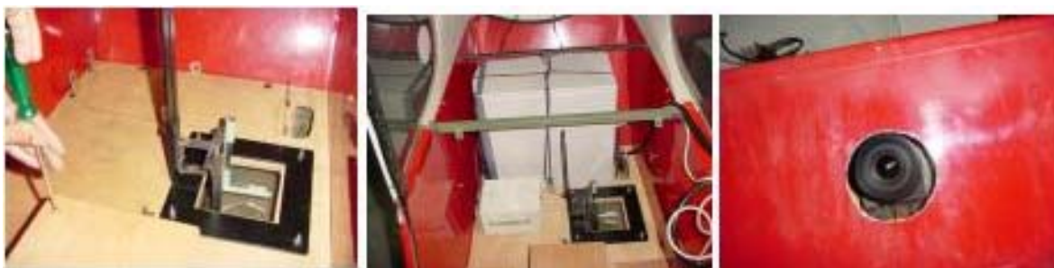
Fig. 02 Suporte e furo no piso da aeronave para instalar a câmara
