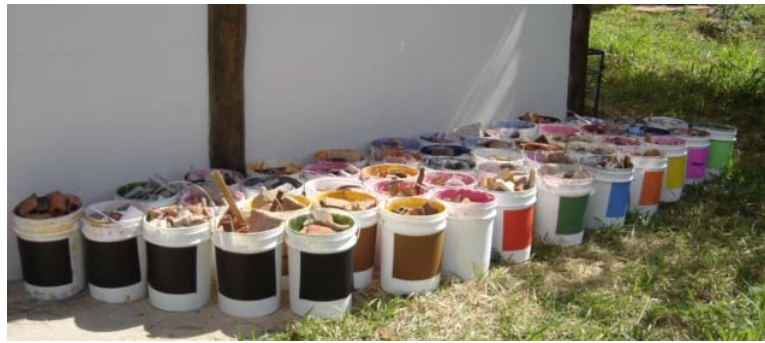
Figura 2 Latas identificadas com amostras coletadas nos diferentes pontos de disposição de RCD na cidade de Bauru.
