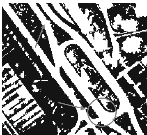
Fig. 7 Eliminação dos buracos nas pistas
