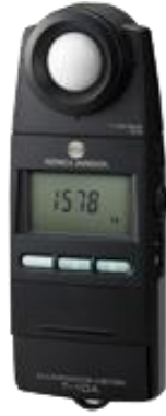
Figura 28. Luxímetro utilizado na medição da iluminância nas diferentes condições de iluminação (Illuminance meter T-10; Konica Minolta Sensing Inc., Japan) Retirado de 84
