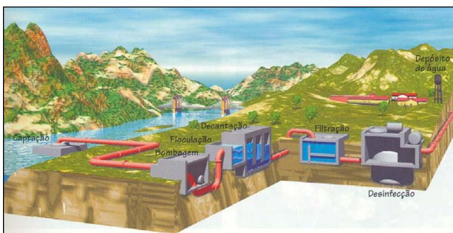
Figura 4.4. Esquema simplificado de algumas etapas do tratamento da água numa ETA (Estação de Tratamento de Água) existente no manual do 5.º ano - Parte 2 (Motta *et al.*, 2002a).
