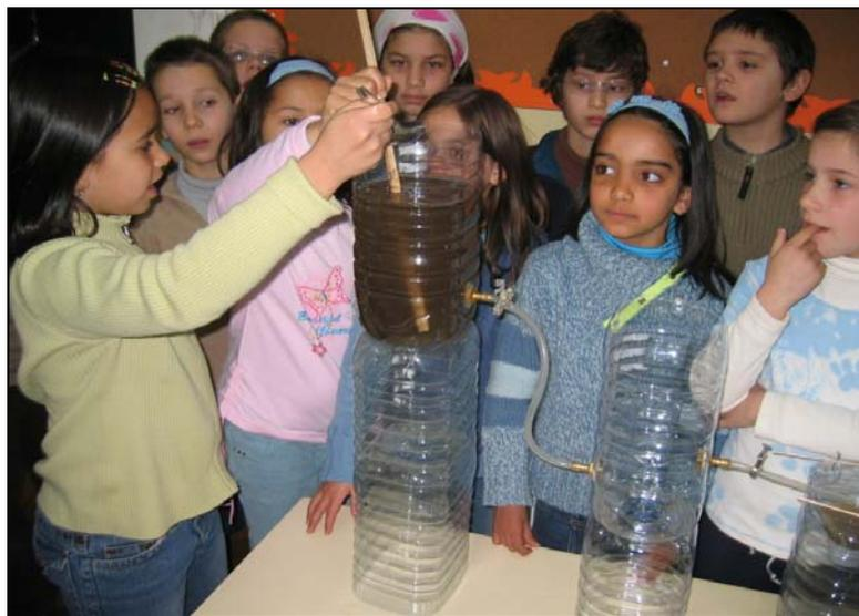
Figura 3.14. Os alunos da turma do 3.º ano a adicionarem a substância floculante à água com solo.
