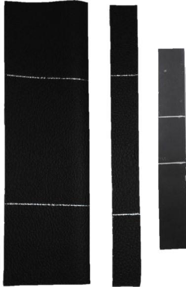
Figura 21 – Provetes utilizados para testar o tamanho. O provete A é o original, o provete B tem 20 mm de largura e 100 mm de altura entre amarras (área limitada pelos traços cinzentos) e o provete c tem 20 mm de largura e 30 mm de altura entre as amarras.
