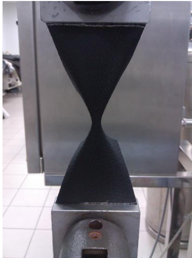
Figura 20 – Ensaio ao material P2, captando o crack tip blunting.
