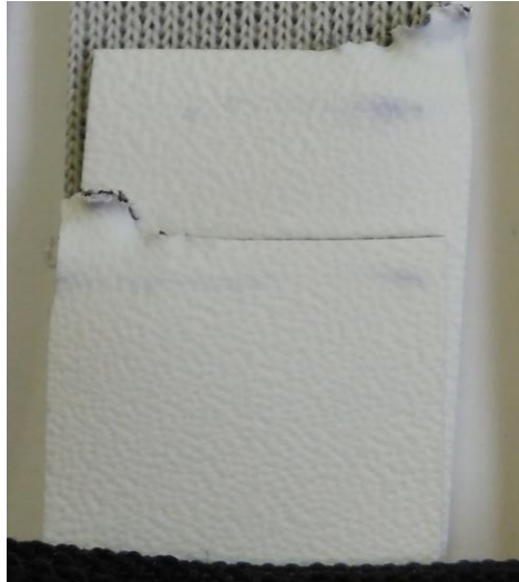
Figura 30 – Provete do material P4T, com sinais de cedência do ligamento.
