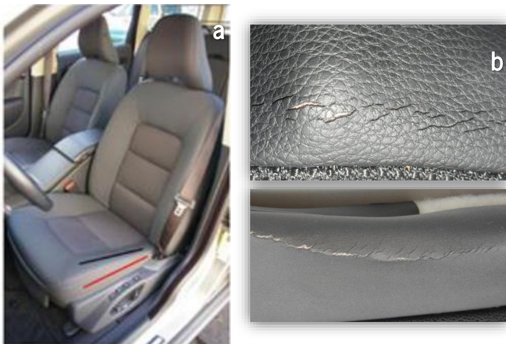
Figura 1 – Em a) assento do carro com as zonas mais comuns de aparecimento de fissuras destacadas a vermelho, a zona 2, e preto, a zona 1. Em b) alguns materiais apresentando fissuras. Adaptado de [1].
