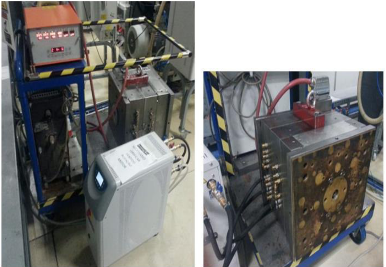
Figura 47-Equipamento do pré-aquecimento do molde
