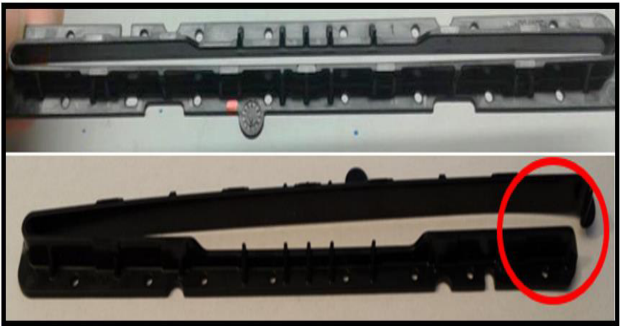
Figura 32-Peça “CD Guide” com falta de enchimento
