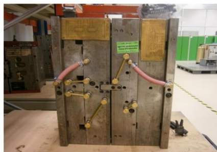
Figura 45-Exemplo de um molde com pontes
