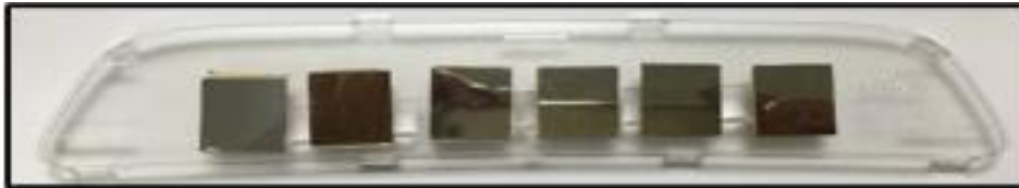
Figura 36- Lente VOLVO HUD revestida com o componente metálico
