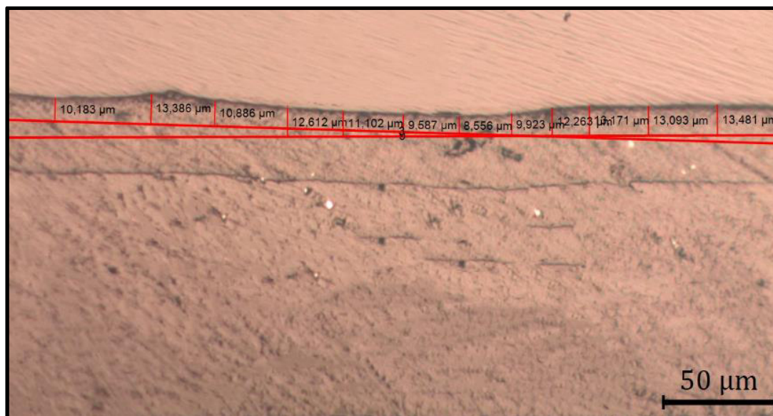
Figura 57- Imagem microscópica com as medições de espessura de tinta na lente Volvo HUD
