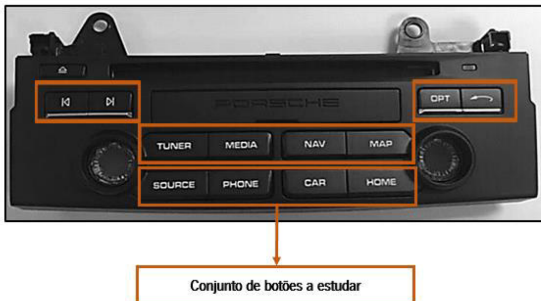
Figura 28- Blenda Porsche montada, com identificação dos botões a estudar
