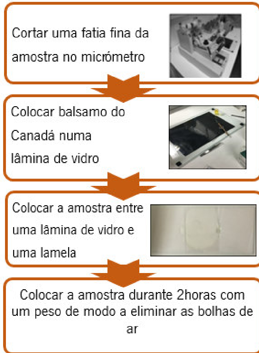
Figura 90- Metodologia seguida na preparação de amostras para análise ao Microscópio de Transmissão
