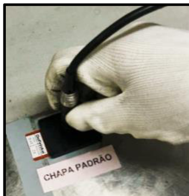
Figura 44-Medição de espessura de tinta com o calibre
