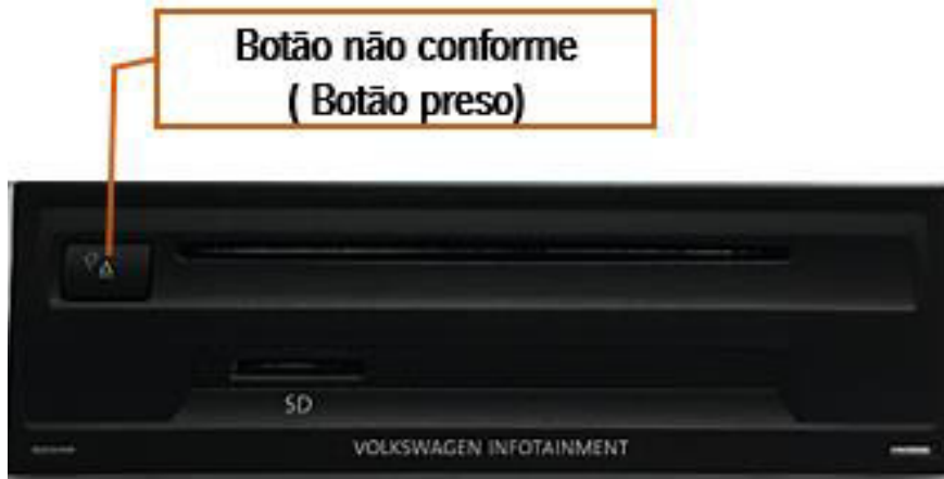
Figura 16- Blenda do MIB produzida com um botão não conforme
