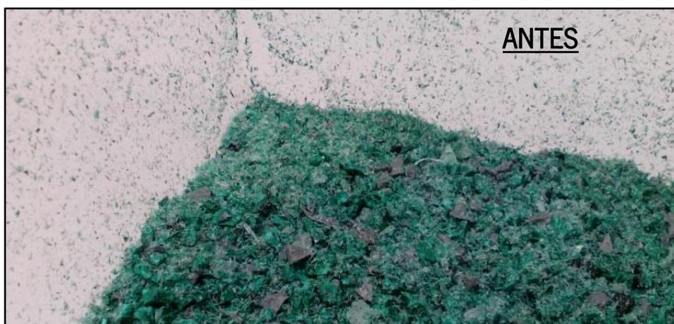
Figura 31 - Material reciclado antes da instalação do despoeirador
