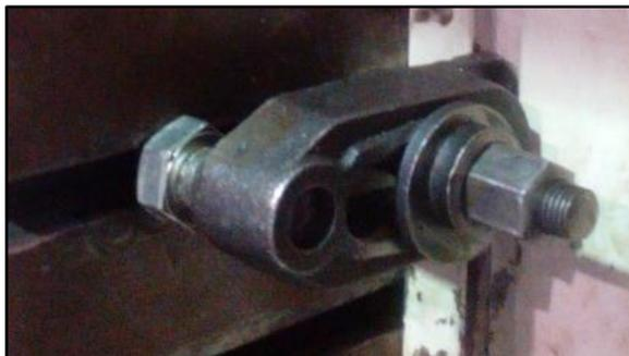
Figura 34 - Cunhas de fixação de moldes utilizado atualmente
