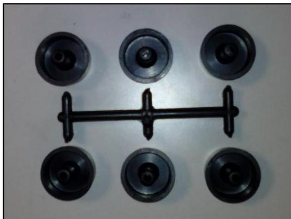
Figura 13 – Molde dos deslizados pouco rentabilizado
