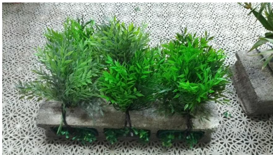
Figura 3-Substratos artificiais agregados na estrutura base.
