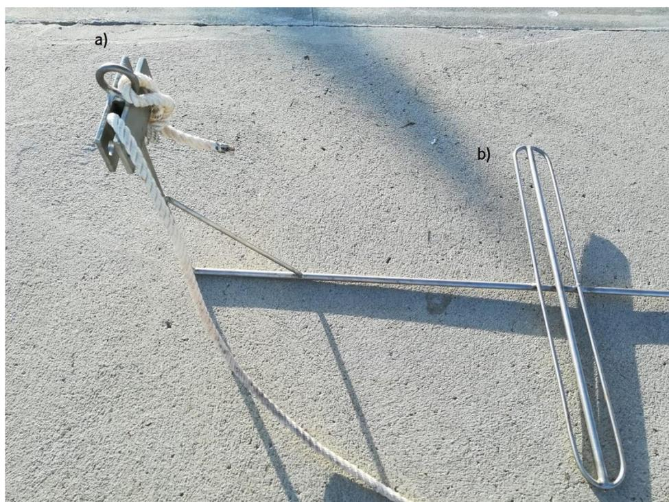
**Figura 5** - Modificações elaboradas ao sistema BRUV após as primeiras amostragens. a) Placa metálica de estabilidade à câmara. b) Adaptação de segurança na base da estrutura.
