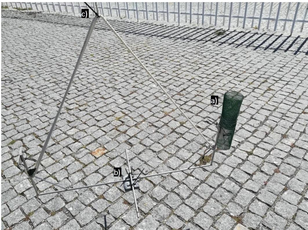
**Figura 4** - Representação final da estrutura utilizada com anexos (exceto câmara). a) Recipiente de plástico para isco. b) Peso de 2 kg para garantir estabilidade a estrutura. c) Corda unida na parte central da estrutura.
