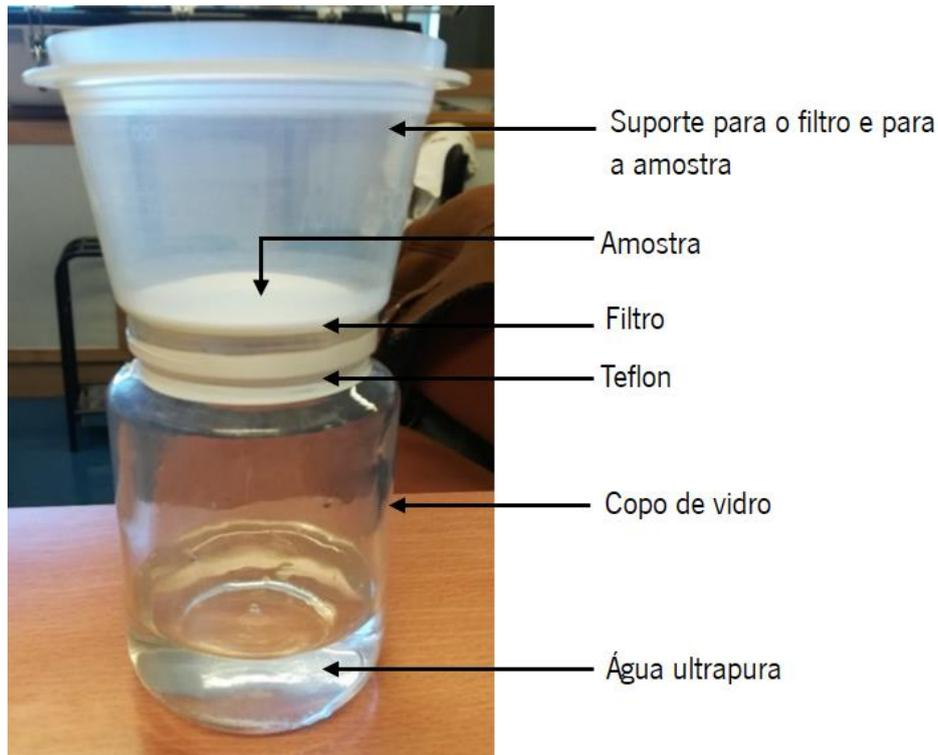
Figura 13 – Fotografia e legenda do sistema utilizado no teste de oclusão.
