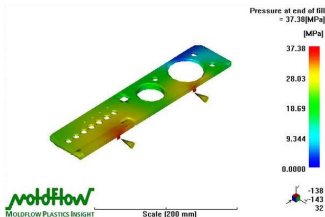
Figura 33 Exemplo de uma simulação no software MoldFlow [15].
