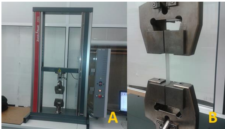
Figura 63 Ensaio de tração na máquina de ensaios Zwick/Roell Z005 – a) Vista geral da máquina; b) Vista pormenorizada do provete para o ensaio de tração.
