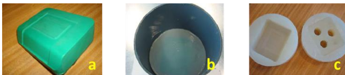
Figura 43 Obtenção do bloco moldante a partir do processo de vazamento de resina na câmara de vácuo – a) Master; b) Formação do Molde em Silicone; c) Molde em Silicone para fazer o vazamento da resina epóxida [16].
