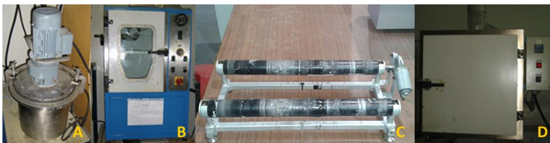
Figura 50 Equipamentos utilizados no processo de vazamento de resina epóxida – a ) Misturadora; b ) Câmara de Vácuo; c ) Equipamento de Anti-Sedimentação; d ) Forno.
