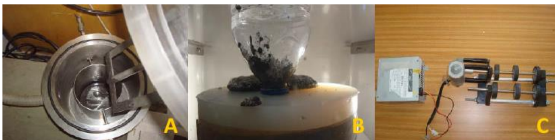
Figura 48 Obtenção do bloco moldante com 15% de fibra curta de aço com resina a partir do processo de vazamento de resina na câmara de vácuo – a ) Compósito de resina epóxida com fibra curta de aço; b ) Vazamento do compósito para o molde de silicone; c ) Máquina anti-sedimentação [16].
