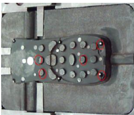
Figura 32 Áreas degradadas na bucha feitas pela maquinação da resina epóxidada [1].
