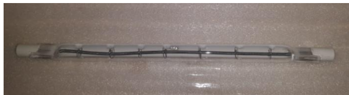
Figura 30 - Lâmpada de halogéneo para emissão de radiação IV.
