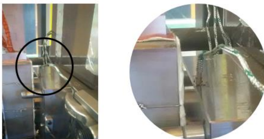
Figura 41 – Termopar da posição um colocado no exterior do molde paralelamente ao suporte de lâmpadas.
