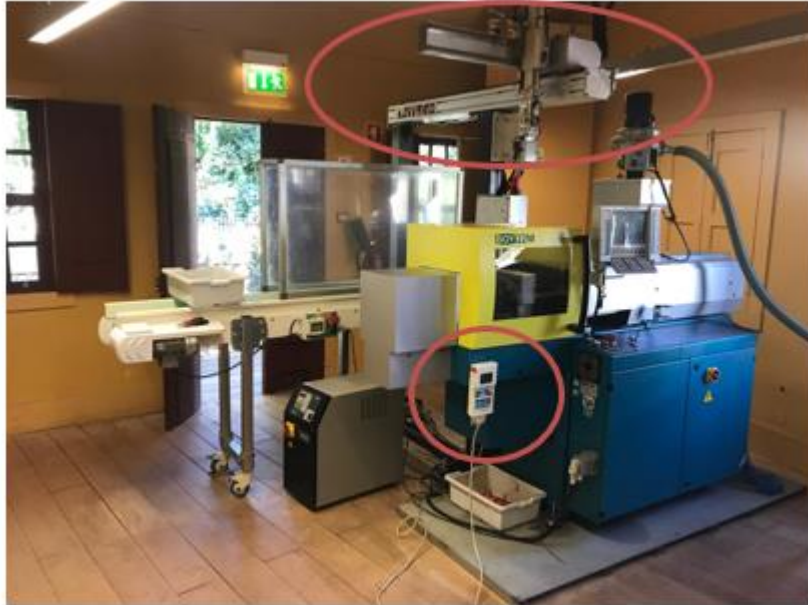
Figura 28 - Manipulador pneumático de três eixos e respetivos comando de controlo dos movimentos.
