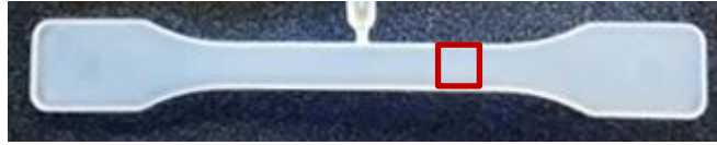
Figura 52 - Preparação da amostra. Corte da amostra entre a zona intermédia dos dois ataques.
