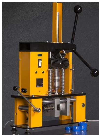
Figura 19 - Equipamento de injeção de bancada Clarke 25. [53]
