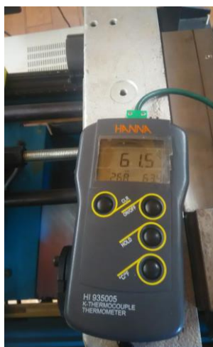
Figura 37- Medição da temperatura à superfície do molde com o uso do termómetro de contacto.
