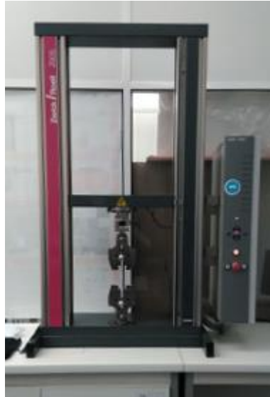
Figura 55 - Máquina de tração Zwick/Roell Z005.
