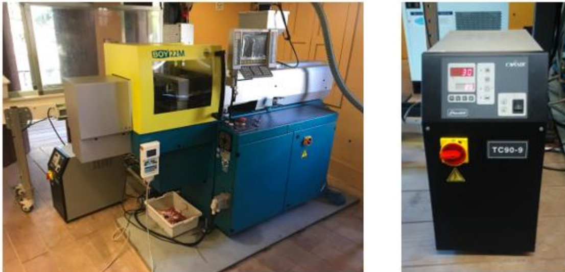
Figura 22 - Injetora Dr.Boy 22M (esquerda), termorregulador Conair Churchill TC90-9 (direita).
