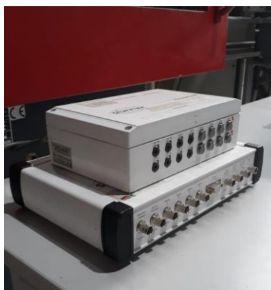
Figura 38 -Sistema de aquisição de dados de temperatura Priamus para leitura dos termopares.
