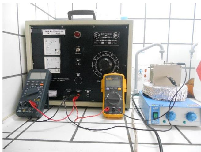
Figura 3.7: Montagem do sistema de anodização utilizado neste trabalho.
