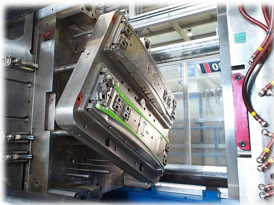
**Figura 15 – Molde bimaternal - rotação de uma placa do molde.**
