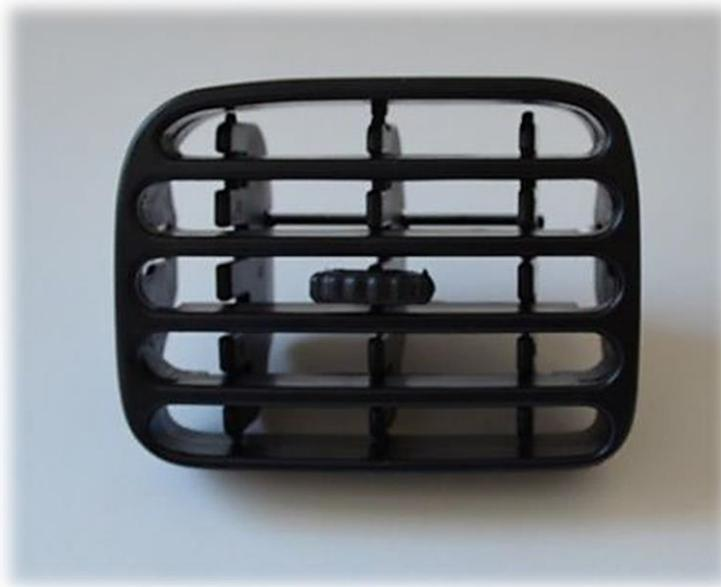
Figura 23 – Exemplo de peça onde não existe adesão entre os materiais
