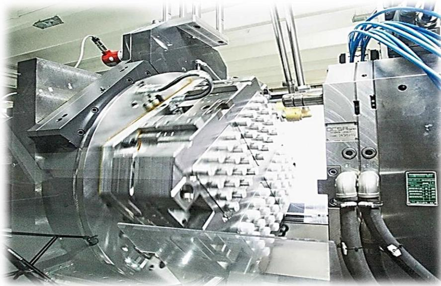
**Figura 13 – Molde bimaterral - rotação da parte móvel.**
