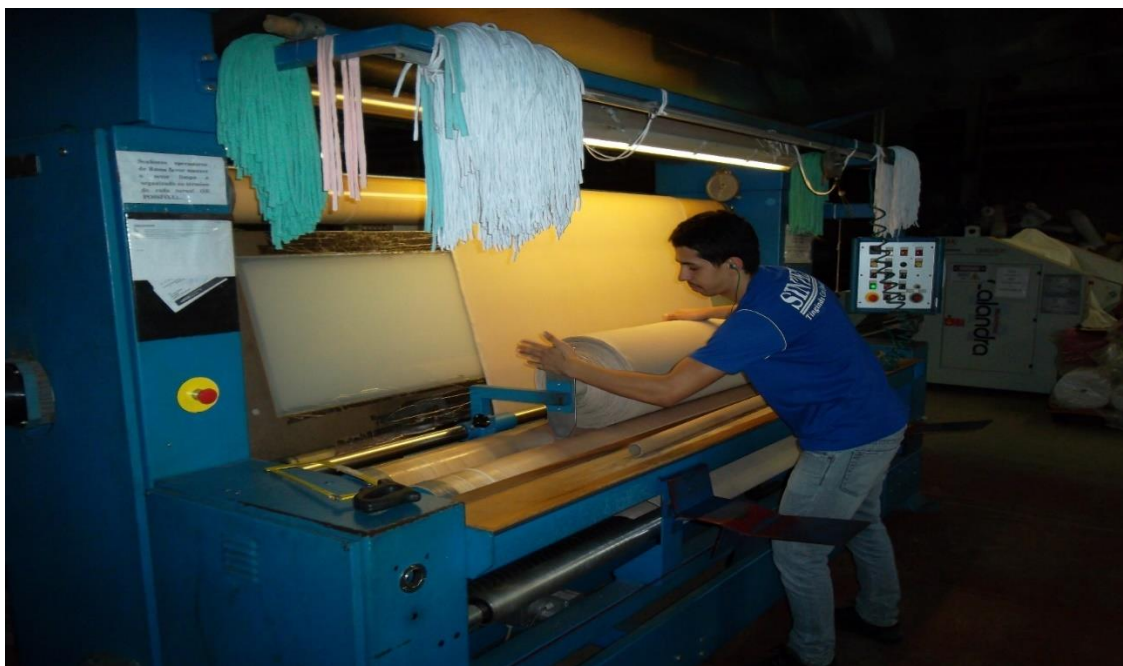
Figura 33: Malha aerado em tratamento na rama da Sintex (própria)
