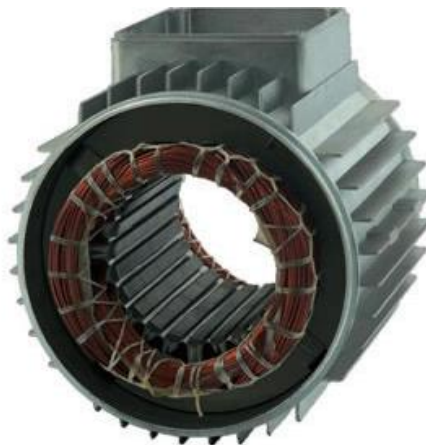
Figura 2.2. Ilustração do estator de um motor de indução trifásico (reproduzido de [30]).
