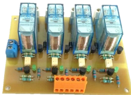
Figura 5.20. Placa de relés para controlo de contactores e lâmpadas de sinalização.
