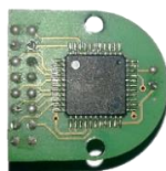
Figura 5.12. Sensor de posição AM512B da RLS .
