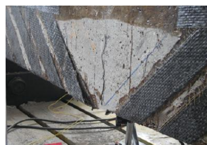
SR7 - Descolagem do CFRP na face inferior
