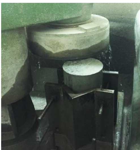
Figura 61 - Processo de retificação dos provetes cilíndricos.
