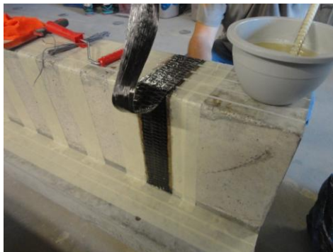
e) Processo de colagem de uma camada de manta
