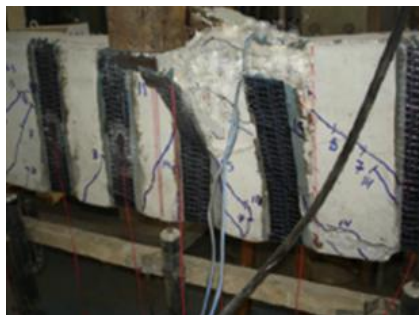
B3S – Descolagem do reforço ao corte
