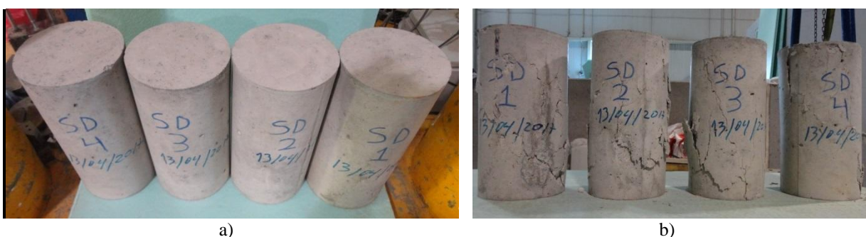
Figura 63 - Provetes cilíndricos: a) antes do ensaio, b) modos de rotura obtidos.
