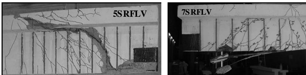
Figura 33 - Modos de rotura das vigas com maior capacidade de carga máxima (Dias e Barros, 2005).
