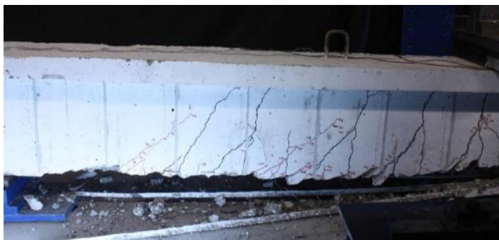
Figura 55 - Modo de rotura da viga reforçada (Costa, 2013).
