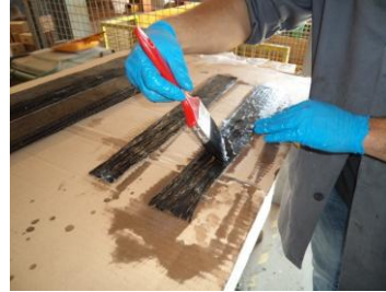
d) Aplicação de resina nas mantas
