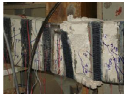
B3FS – Ruptura do reforço de flexão seguido de descolagem do reforço de corte
