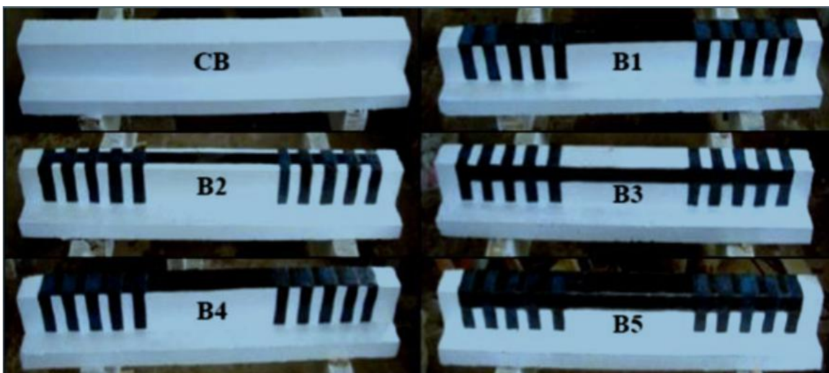
Figura 49 - Vigas testadas por Salib (2012).
