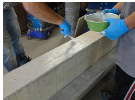
f) Acabamento final com remoção do adesivo em excesso
