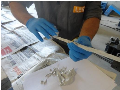
c) Aplicação do adesivo no laminado.
