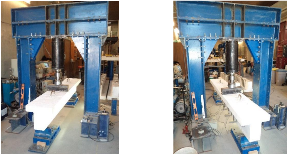
Figura 74 - Sistema de ensaio das vigas.
