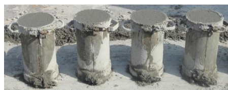
Provetes cilíndricos betonados para caracterização do betão
