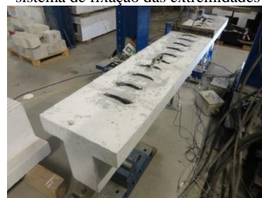
k) Aspeto geral da viga reforçada
