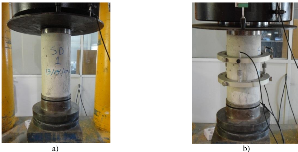
Figura 62 - Configuração dos ensaios realizados para a caracterização do betão: a) resistência à compressão, b) módulo de elasticidade.
