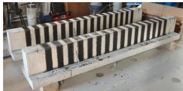
h) Aspeto geral das vigas após o reforço ao corte
