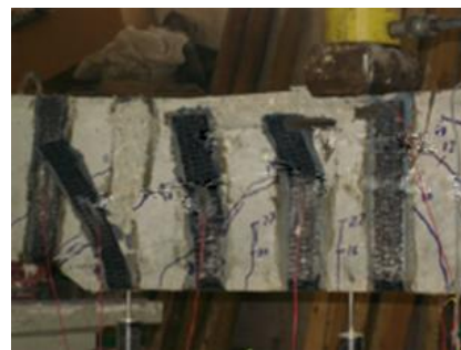
B2S – Descolagem do reforço de corte
