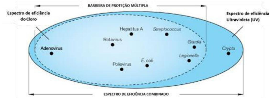
Figura 3: Espectro de microrganismos atingidos pela desinfecção por cloro e pela desinfecção por UV. (Imagem adaptada de Trojan UV)
