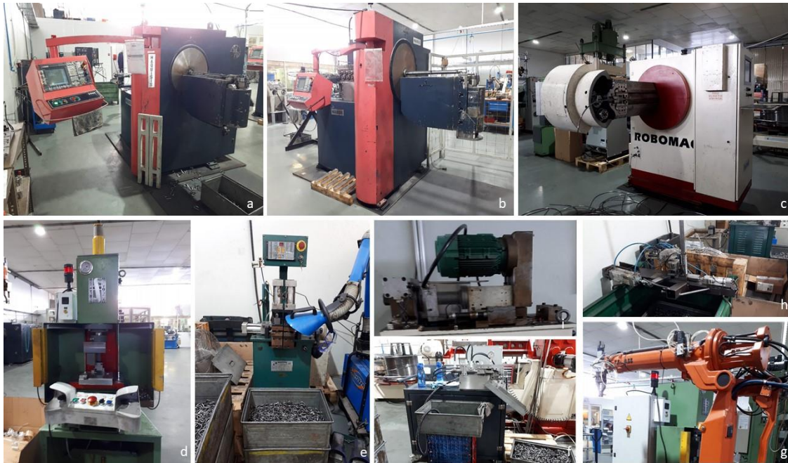
Figura 8. Máquinas do setor de arames: a - Maquisis NC 3D6; b - Maquisis NC 3D13; c - Latour Robomac 216 CNC; d - Prensa Hans Schoen TEM; e - MotorFil; f - Ferramenta de dobrar e teste da argola; g - Robot ABB; h - Ferramenta de apoio; i – Boleador.
