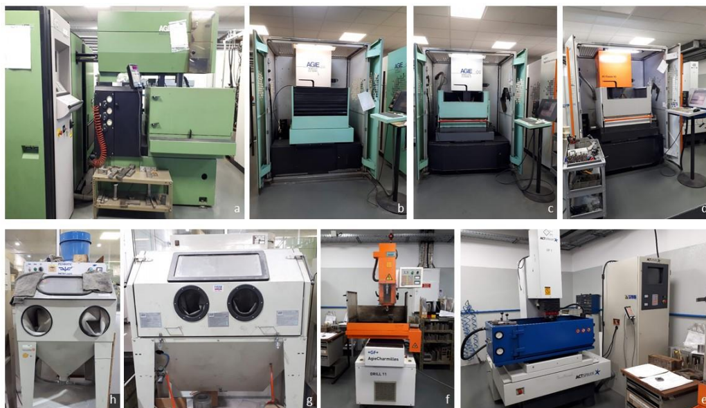
Figura 25. Máquinas de Eletro Erosão e Granalhagem: a - AgieCut 100D; b - AGIECUT Classic; c - AGIECUT Classic 2S; d - Agie Charmilles AC Classic V2; e - ACTSPAK SP1; f - AGEDRILL Charmilles 11; g - SBC 420; h - PEENMATIC Micro 600S.
