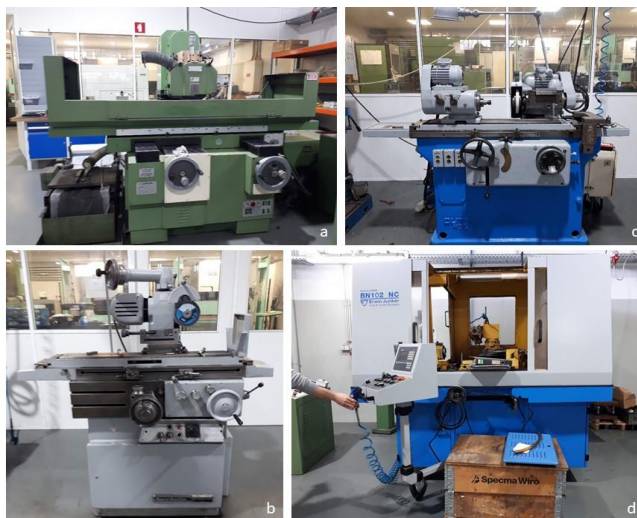
Figura 24. Máquinas de Retificação: a - STEFOR RTB 8/5; b - Tachella I4am; c - CUTTA ROUC; d - Erwin Junker BN102 NC.
