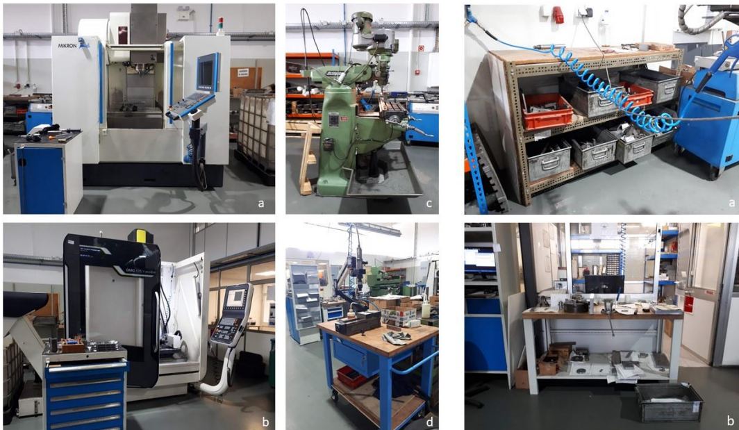
Figura 20. Máquinas da Fresagem: a - Mikron VCE 800Pro; b - DMG DMC 635 Ecoline; c - Bridgeport BR2J; d - Braço de auxílio
