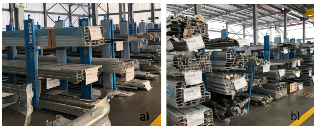
Figura 44- Armazém de perfis: a) antes; b) depois com mais um berço.
