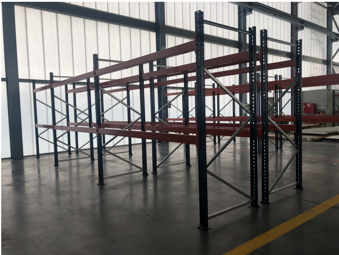
Figura 46- Estantes de armazenamento de material para produção nas boxes L11 e L12.
