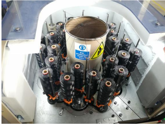
Figura 20- Interior de máquina com 24 canelas
