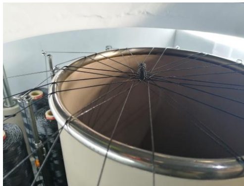
Figura 47- Novelos de fio deve ser mantido próximo do centro
