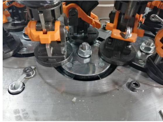
Figura 21- Pormenor do sistema de funcionamento de rotação das canelas
