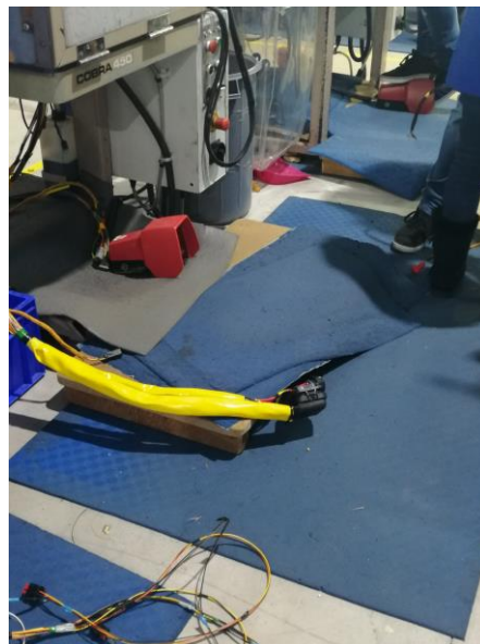
Figura 43 - Tapetes ergonômicos não seguros e cabos no chão
