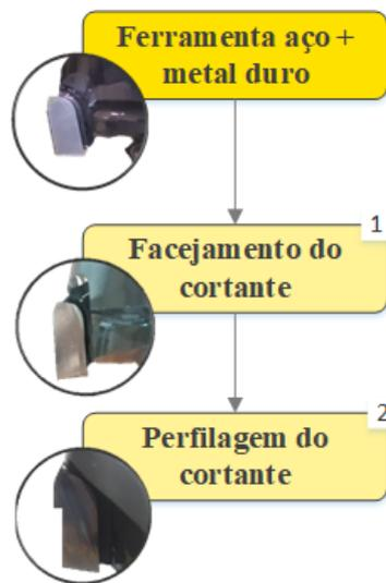
*Figura 23 - Fluxo de operações no centro de Fresagem HM – Família AÇO*
