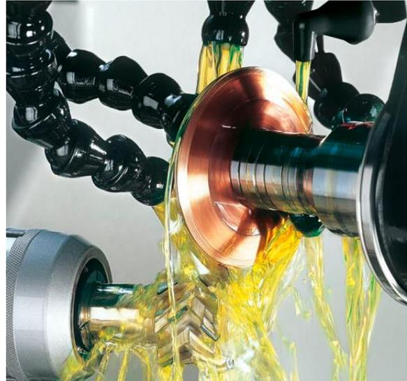
Figura 20 - Trabalho de mó em máquina CNC
