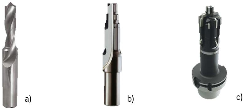
Figura 16 - Ferramentas de corte das famílias a) HM b) PCD c) AÇO
