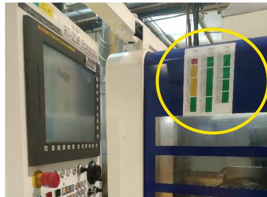
*Figura 43 - Tabela técnica afixada nas máquinas*
