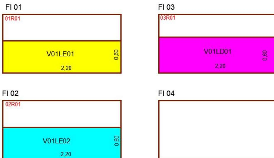
Figura 16: Diagramação do plano de corte após o uso do terceiro contraplacado.
