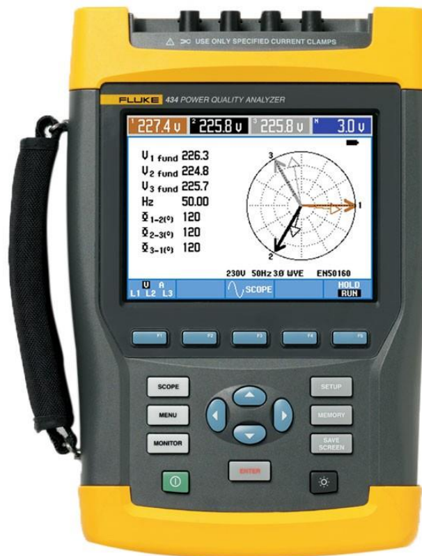
Figura 2.11. Analisador da qualidade de energia Fluke 434 (Fonte: Fluke ) [31].
