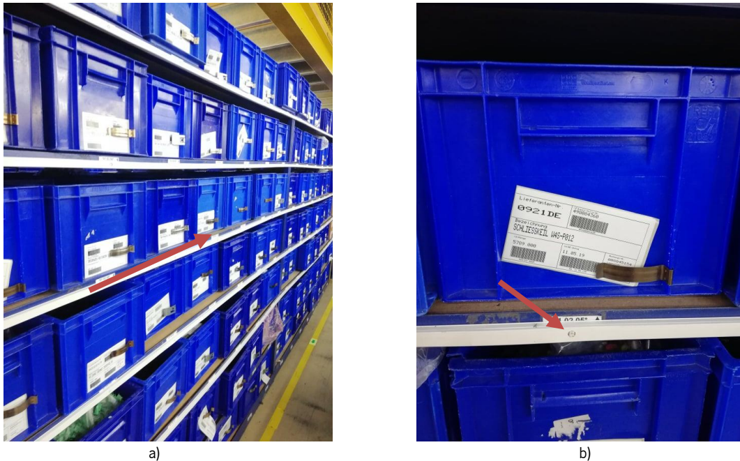
Figura 59 - a) Sistema pick to light numa das estantes; b) Posição do led no sistema pick to light
