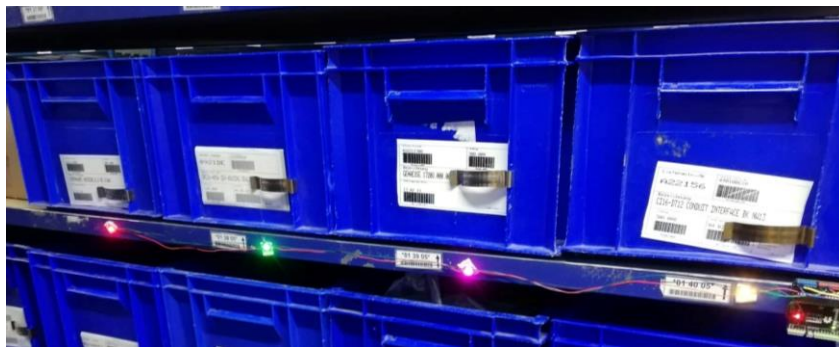
Figura 58 - Sistema pick to light em fase de testes
