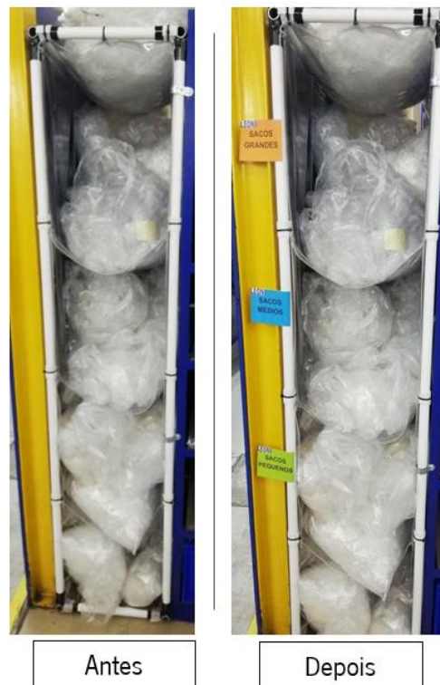
Figura 74 - Antes e depois da aplicação das etiquetas nas lonas
