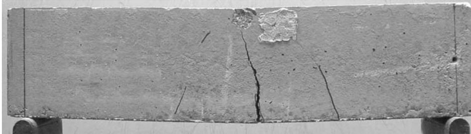
Figura 7 – Configuração de rotura por flexão.
