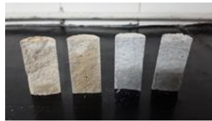
Figura 14. Visualização da ascensão capilar
