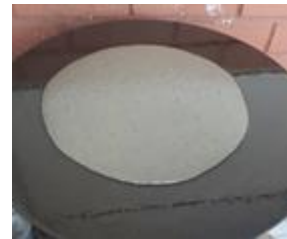
Figura 10. Argamassa após espalhamento
