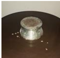
Figura 9. Molde preenchido com argamassa
