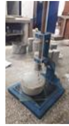
Figura 8. Penetração da agulha de Vicat
