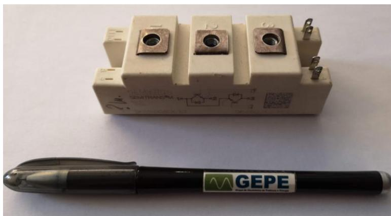
Figura 4.19. Módulo *SKM100GB12T4* da *Semikron*.
