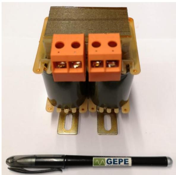
Figura 4.21. Bobina de núcleo partilhado para acoplamento com a rede.
