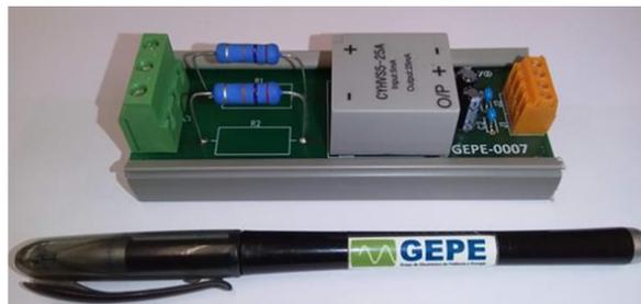
Figura 4.4. Placa de Sensor de Tensão (vista lateral).
