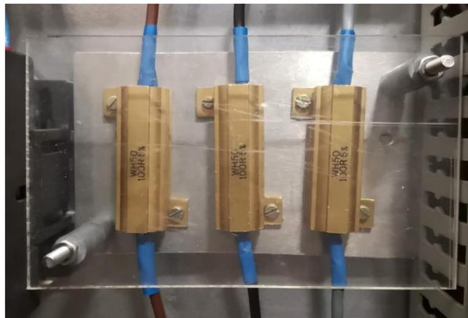
Figura 4.25. Resistências de pré-carga.
