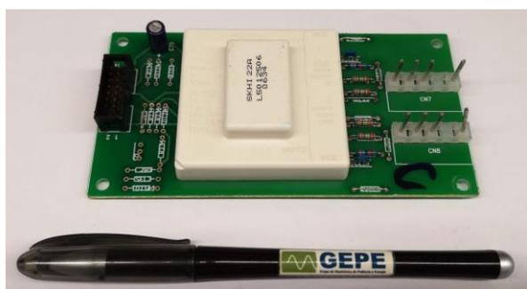
Figura 4.14. Placa de Driver dos IGBTs.
