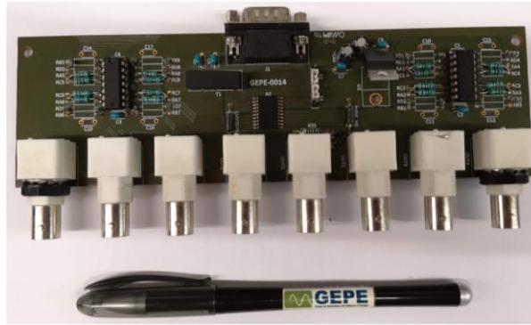
Figura 4.10. Placa de DAC (vista superior).
