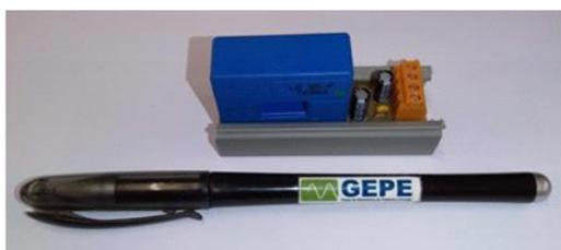
Figura 4.5. Placa de Sensor de Corrente (vista lateral).
