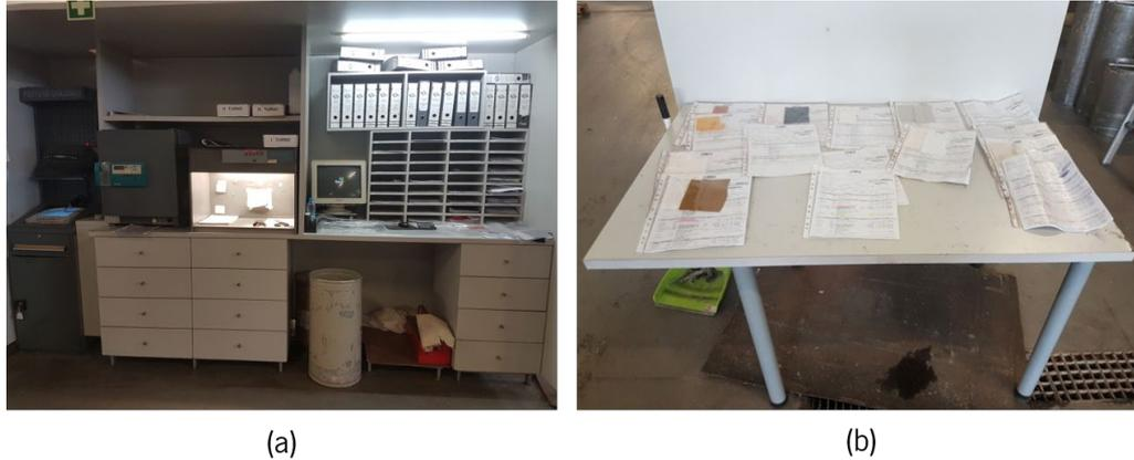
Figura 70. (a) Posto de controlo da secção de tinturaria onde se acede às informações acerca do estado do processo. (b) Mesa de apoio, ao lado do posto de controlo, onde se colocam e consultam as folhas das OS's em processamento.
