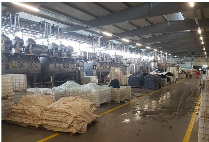
Figura 71. Zona de armazenamento temporário 3 evidenciando a colocação aleatória dos materiais usados na secção de tinturaria.
