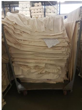
Figura 27. Exemplo de carro com partida preparada para a secção de tinturaria.
