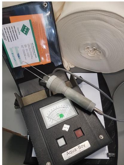
Figura 72. Medidor de humidade utilizado no estudo do teor de humidade das malhas.
