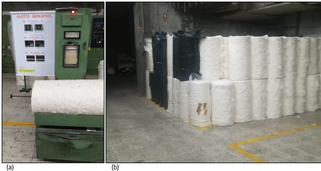
Figura 22 - (a) Balança para pesagem de mantas; (b) Stock de mantas.
