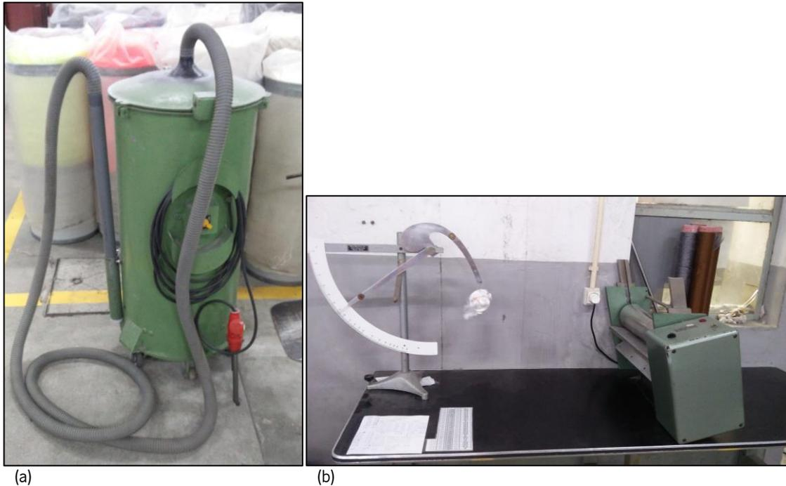
Figura 41 - (a) Aspirador; (b) Estação de verificação do Ne.
