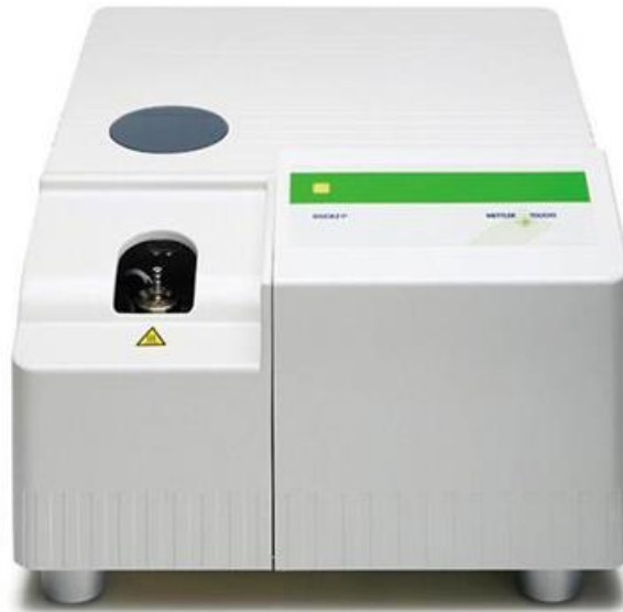
Figura 29: DSC 822e da Mettler Toledo , com uma capacidade do forno de 200W, intervalo de temperatura entre -65 a 500°C, com intercooler e uma velocidade de aquecimento/arrefecimento de 1 a 20K/min.
