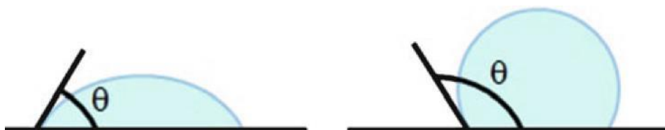
Figura 22: Ângulo de contacto de uma superfície hidrófila e de uma superfície hidrófoba.
