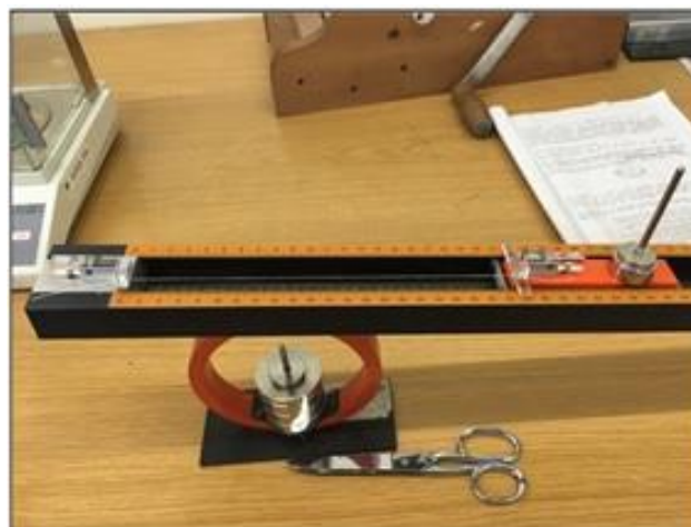
Figura 19: Determinação da contração dos fios do tecido através do Crimptester .
