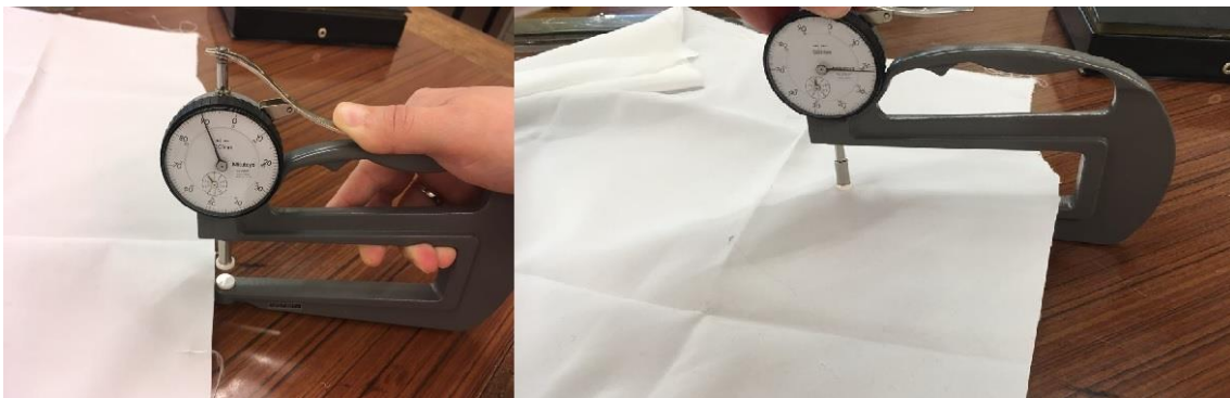
Figura 17: Verificação da espessura do artigo em estudo.
