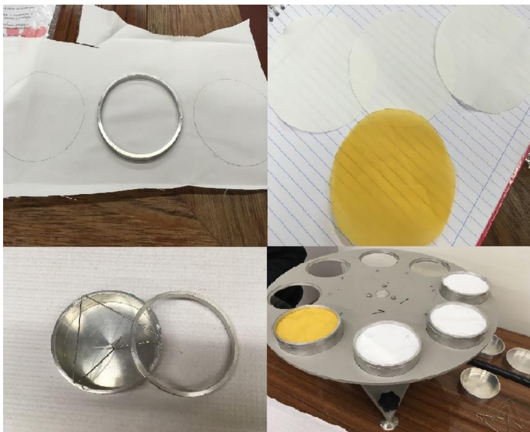
Figura 24: Ensaio de permeabilidade ao vapor de água.
