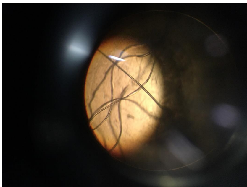
Figura 33: Vista longitudinal obtida pelo microscópio (fios de teia).
