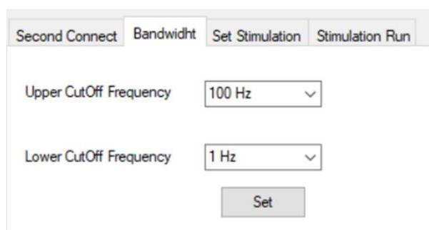
Figura 39-Separador para modificar largura de banda.
