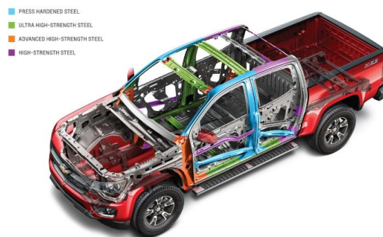
Fig. 1.4 – Utilização de aços avançados de elevada resistência no body da pick-up Chevrolet Colorado 2015 (Wendy, 2015).
