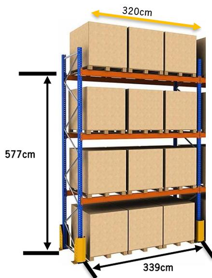
Figura 14: Dimensão das *Racks* de Armazenamento
