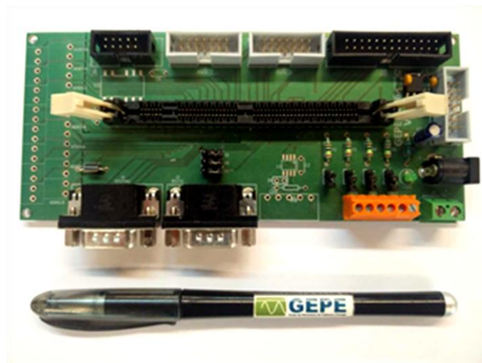
Figura 4.2. Placa de suporte do DSP.
