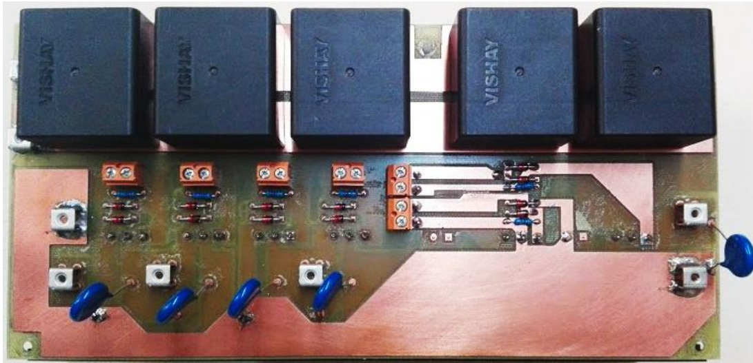
Figura 4.17. Placa do conversor CC-CC e do inversor do tipo fonte de corrente monofásico.
