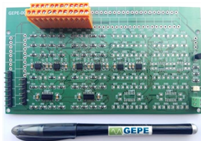
Figura 4.5. Placa de condicionamento de sinal e deteção de erros utilizada.
