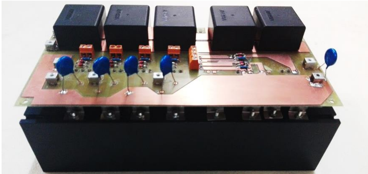
Figura 4.19. Placa do conversor CC-CC e do inversor do tipo fonte de corrente monofásico fixada no dissipador.
