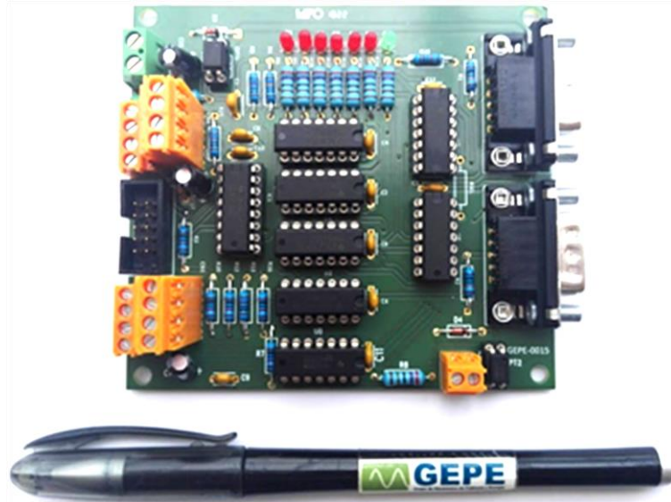
Figura 4.8. Placa de comando monofásica utilizada.
