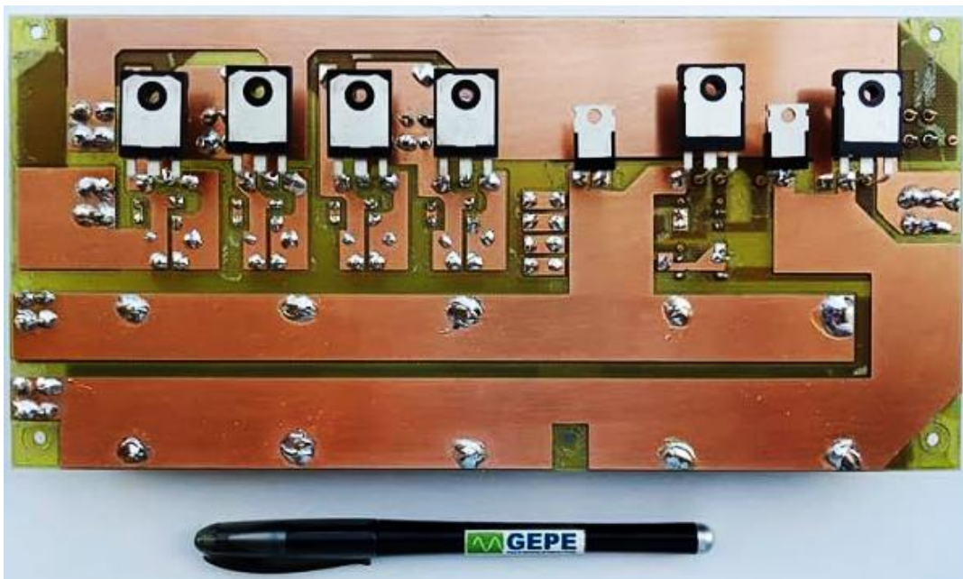
Figura 4.18. Placa do conversor CC-CC e do inversor do tipo fonte de corrente monofásico vista da parte inferior.
