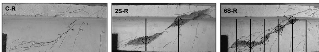
Figura 7: Modo de rotura das vigas sem reforço ao corte com CFRP
