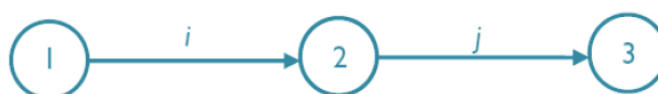
Ilustração 10 - Representação de um diagrama de atividades com o formato Activity-on-Arc (AoA) (Tereso, 2016a)
