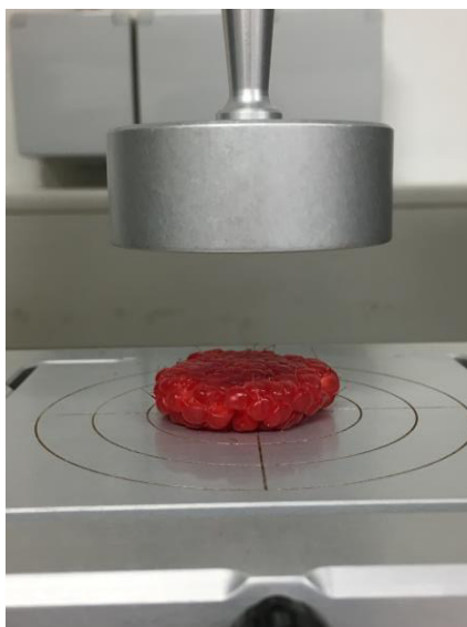
Figura 21. Teste de compressão com sonda PA-25 no texturómetro.
