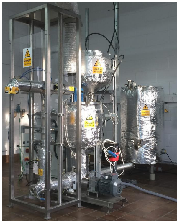
Figura 34. Reator óhmico à escala piloto (“C-Tech Innovation,” 2018).
