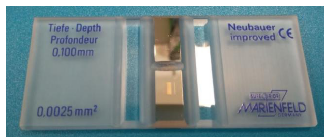
Figura 10. Câmara de Neubauer para contagem celular.
