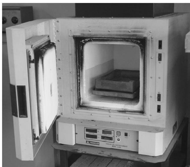
Figura 4.5 – Mufla para incineração do betume das misturas betuminosas
