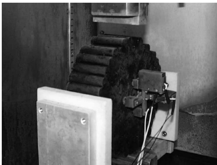
Figura 7.15 – Provette sintético ensaiado à tracção indirecta (Buttlar and You, 2001)
