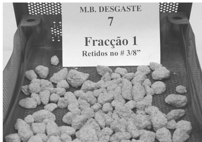
Figura 4.6 – Agregados da fracção 1 da mistura betuminosa de desgaste 7 após a incineração do betume
