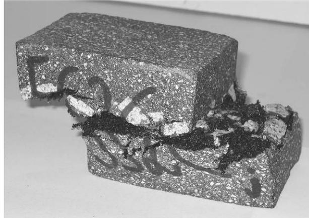
Figura 5.10 – Zona de rotura observada nos ensaios de corte
