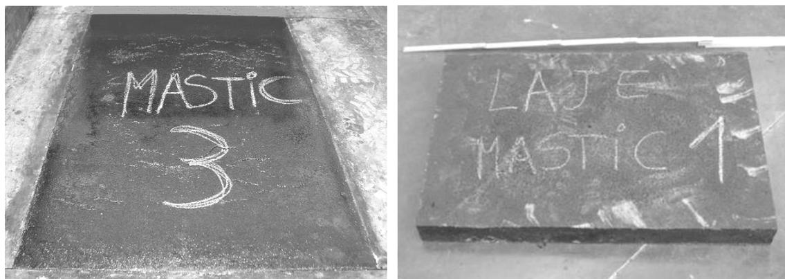
Figura 4.21 – Lajes preparadas com mastique
