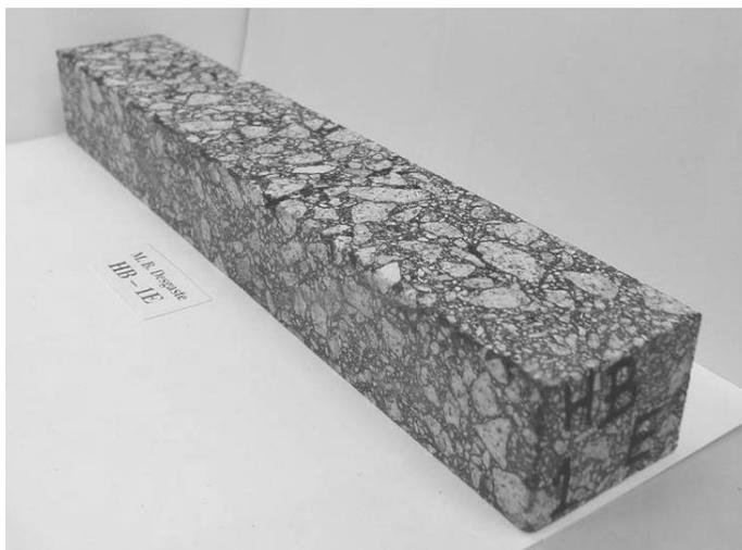
Figura 6.6 – Viga utilizada no ensaio flexão repetida em quatro pontos
