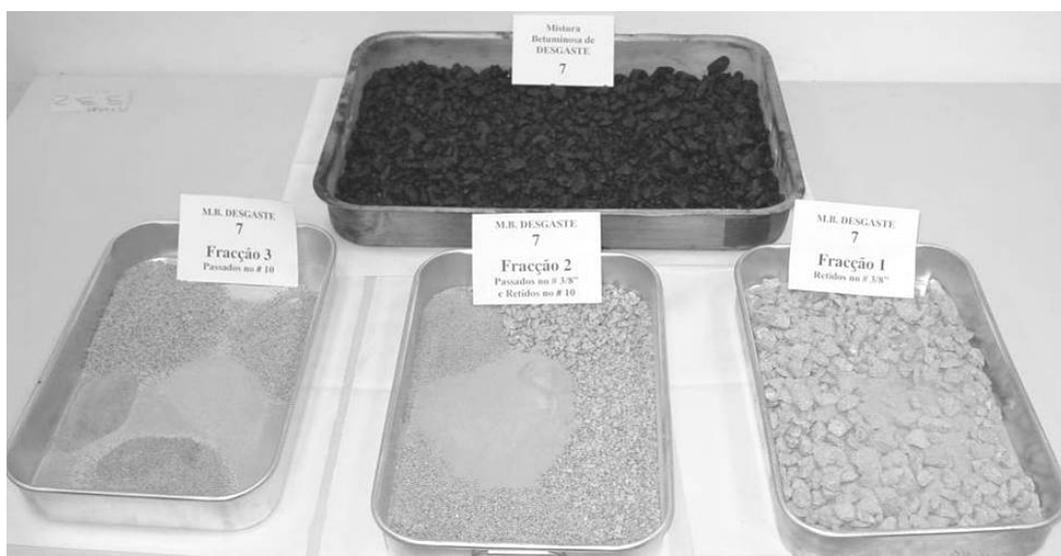
Figura 4.7 – Granulometria das diversas fracções da mistura betuminosa de desgaste 7
