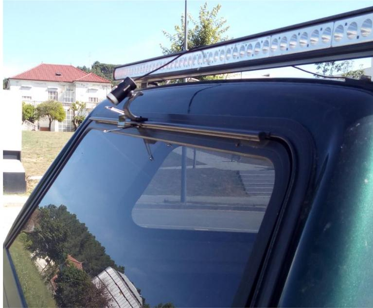
Figura 33: Posicionamento da câmara fotográfica na parte exterior traseira da carrinha
