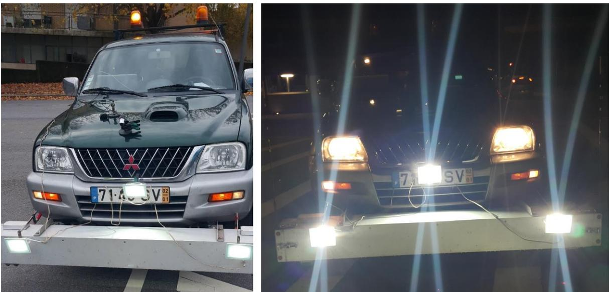
Figura 34: Sistema de iluminação artificial com holofotes aplicado no veículo
