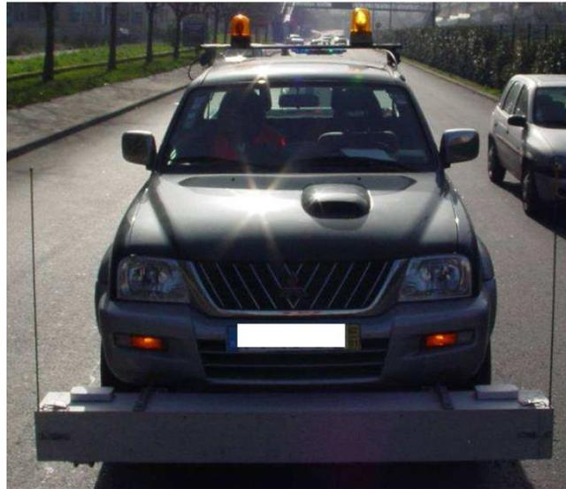
Figura 16: Barra fixa utilizada no veículo de ensaio para a medição da irregularidade (IRI) e da macrotextura (MPD).
