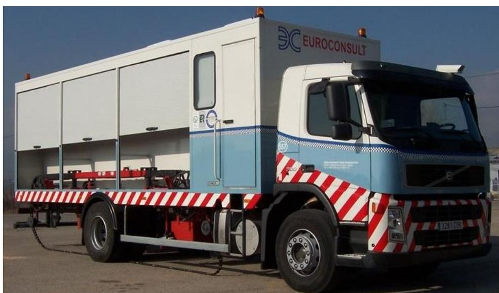
Figura 11: Camião que transporta o curviâmetro (Motorpress Ibérica, 2018)
