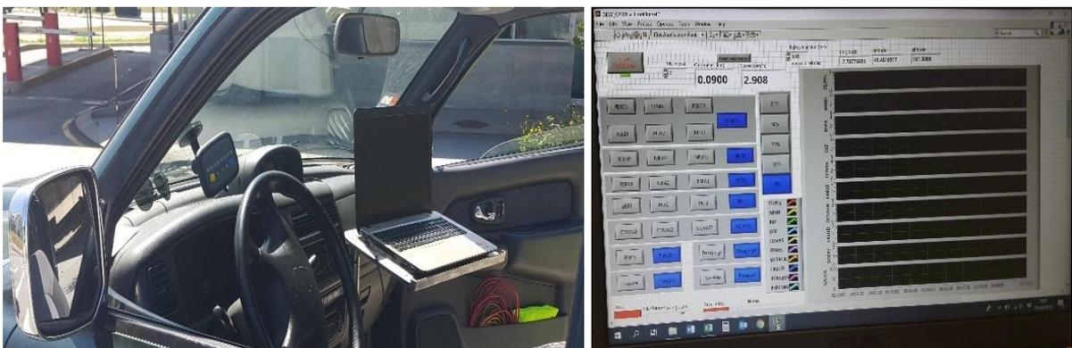
Figura 30: Sistema utilizado neste trabalho para levantamento do estado superficial do pavimento com apoio computacional e respetivo *software*
