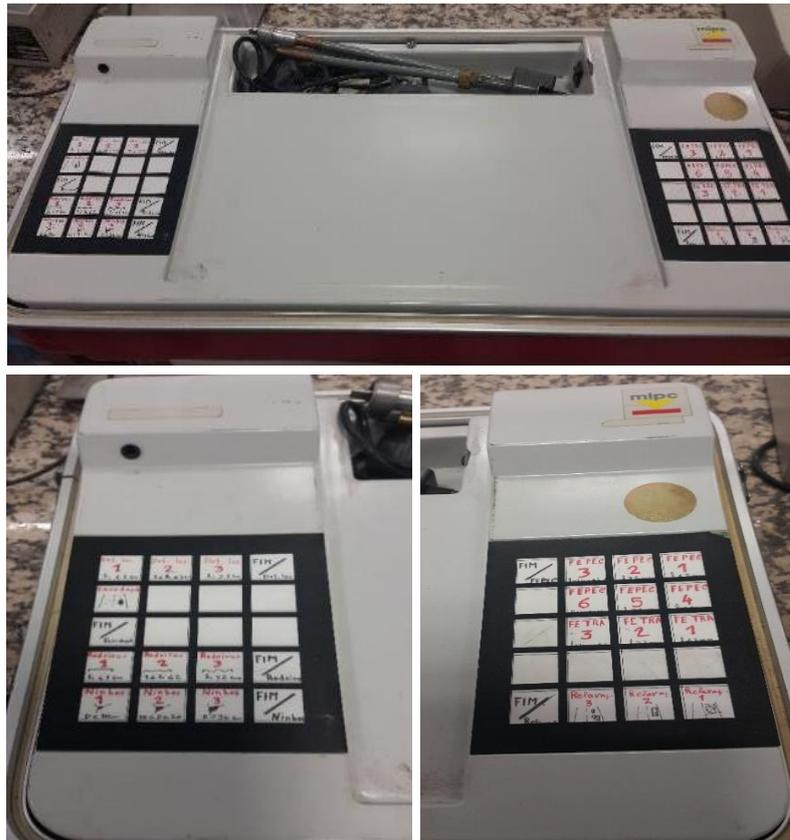
Figura 29: Equipamento do tipo Desy, da Universidade do Minho, para apoio computacional na observação do estado superficial de pavimentos
