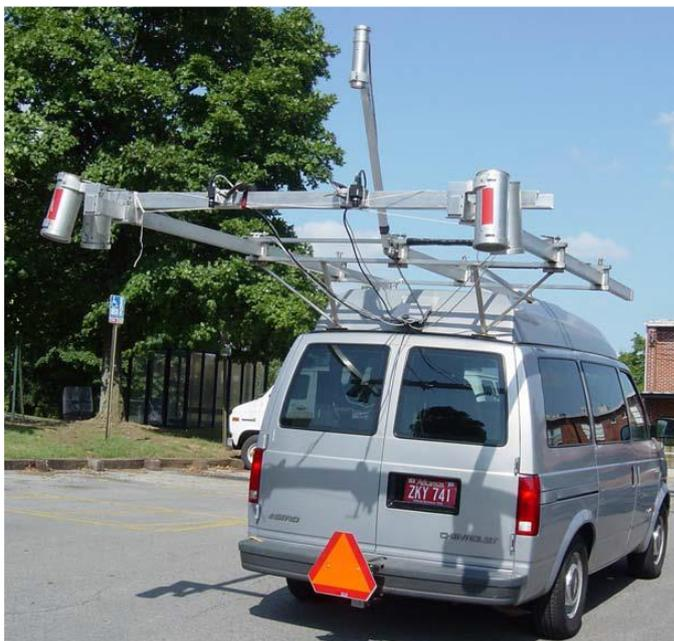
Figura 7: Equipamento para obtenção de imagens digitais da degradação do pavimento (Wang, 2004).
