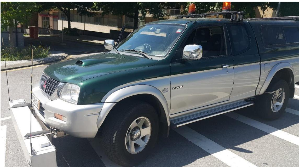
Figura 27: Carrinha da Universidade do Minho utilizada nos levantamentos do estado superficial do pavimento com apoio computacional ou fotográfico.
