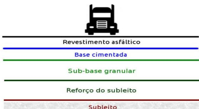
Figura 3: Estrutura de um pavimento semirrígido (ECivil, 2018).
