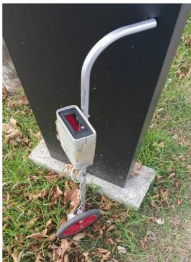
Figura 26: Odómetro eletrónico utilizado para medição das distâncias no trecho em estudo
