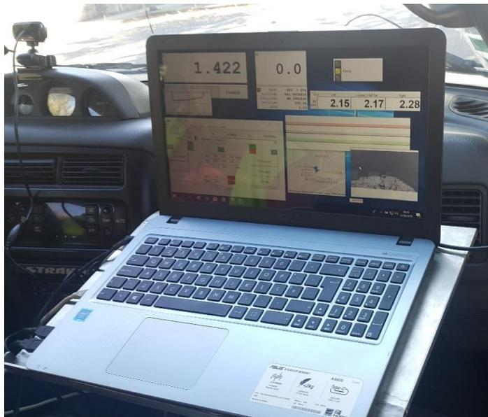
Figura 28: Computador de bordo utilizado para controlo, aquisição e registo de dados nos levantamentos do estado superficial do pavimento com apoio computacional ou fotográfico.
