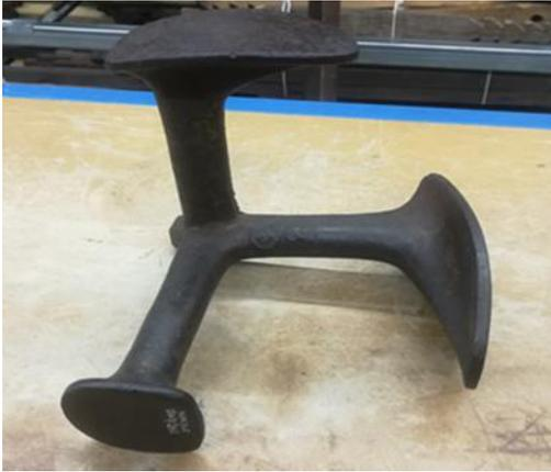
Figura 29- Forma de ferro usada para pregar e bater as solas.
