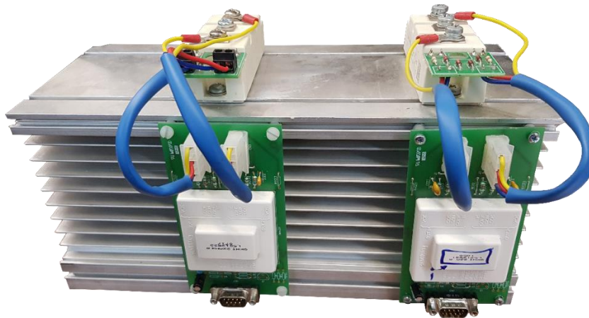
Figura 5.22 – Módulos colocados no dissipador juntamente com os drivers.
