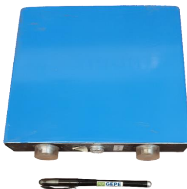
Figura 5.25 – Bateria do tipo LiFePO 4 .
