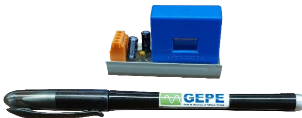
Figura 5.7 – Sensor de corrente e respetiva placa de ligação.
