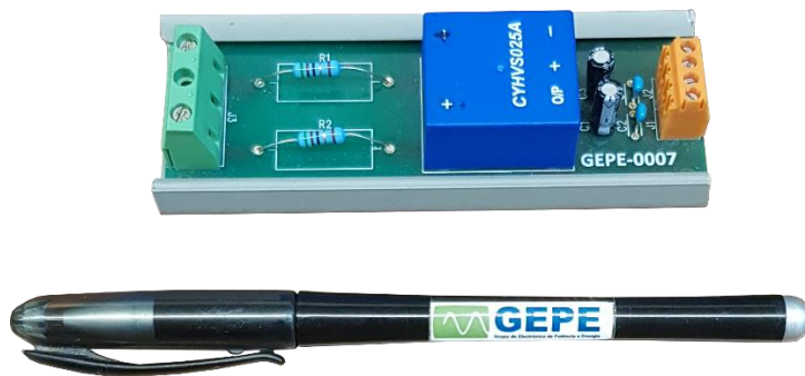
Figura 5.4 – Sensor de tensão e respetiva placa de ligação.
