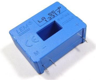
Figura 5.5 – Sensor de corrente utilizado na bateria.
