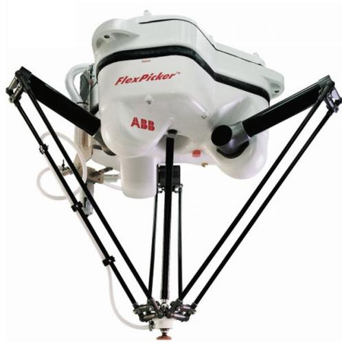
(a) Estrutura mecânica paralela.
