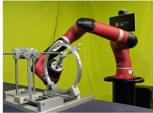
(c) Registo do ponto  ${}^S\vec{P}_3 = [80, 0, 0]^T$  (mm). (d) Registo do ponto  ${}^S\vec{P}_4 = [0, 80, 0]^T$  (mm).
