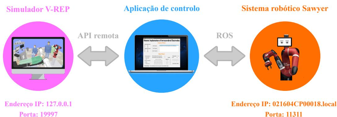
**Figura 7.1:** Comunicação entre a aplicação de controlo (azul) e as diferentes plataformas robóticas: simulador V-REP (rosa) e Sawyer (laranja).
